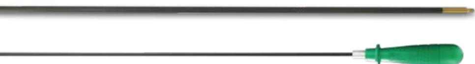
**Ausführung:** Alle Putzstäbe auch als Set inkl. Wechselgriff und Adapter verfügbar. Wischlänge Putzstab kurz: 22 cm. Zur Verschraubung am Griffstück ist ein M5 Außengewinde angebracht. Zur Aufnahme von Adaptern und Bürsten Gewinde in Artikelbeschreibung beachten.
